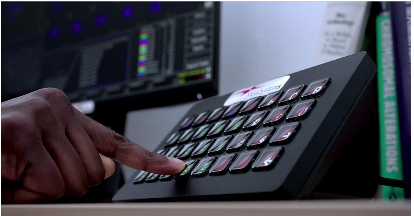
图 2：用可编程的 RapidScore 键盘，只需一个按键就可以即时确认或纠正自动输出的信息。
