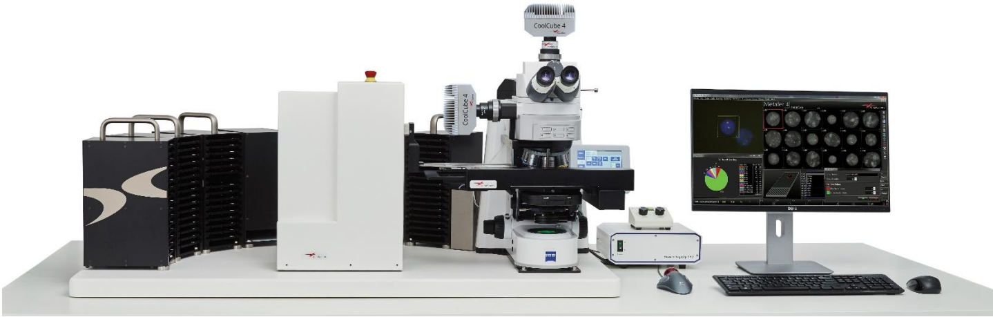
图 5：用于间期 FISH 斑点成像的 Metafer 驱动玻片扫描装置。这包括一台配有一个或两个摄像头的电动显微镜，以及一个步进电机载物台。为了增强扫描能力，一个自动玻片送片机器人装置（Slideeeder x80；位于左侧），可以为显微镜载物台每次运行提供多达 800 个玻片。此外，还集成了一个条形码阅读器，以自动识别玻片，并将样品分配给相应的病例和搜索信息文件（SIF）。
